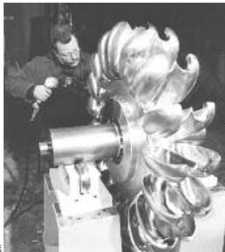
Turbine Pelton pour centrale microhydraulique.
