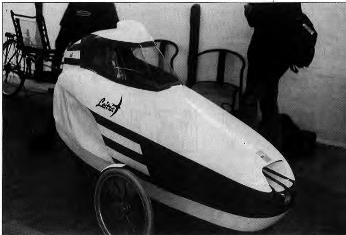
Vélo du futur : le tricycle caréné. L'un des vélos les plus performants à l'heure actuelle : on est assis comme dans une voiture ; on est à l'abri des intempéries ; le carénage assure une très bonne entrée dans l'air : on fonce sans se fatiguer ! Il nécessite des pistes cyclables larges.
