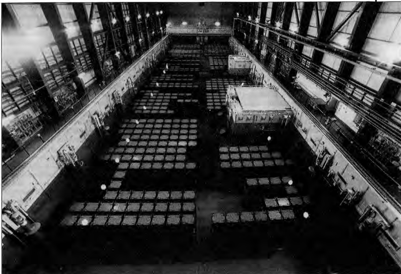
La Hague : piscine de stockage intermédiaire d'UP3, usine de retraitement des déchets radioactifs. L'option retraitement a été préférée au stockage direct essentiellement pour des raisons militaires (récupération du plutonium et de l'uranium). Photo AIEA)
