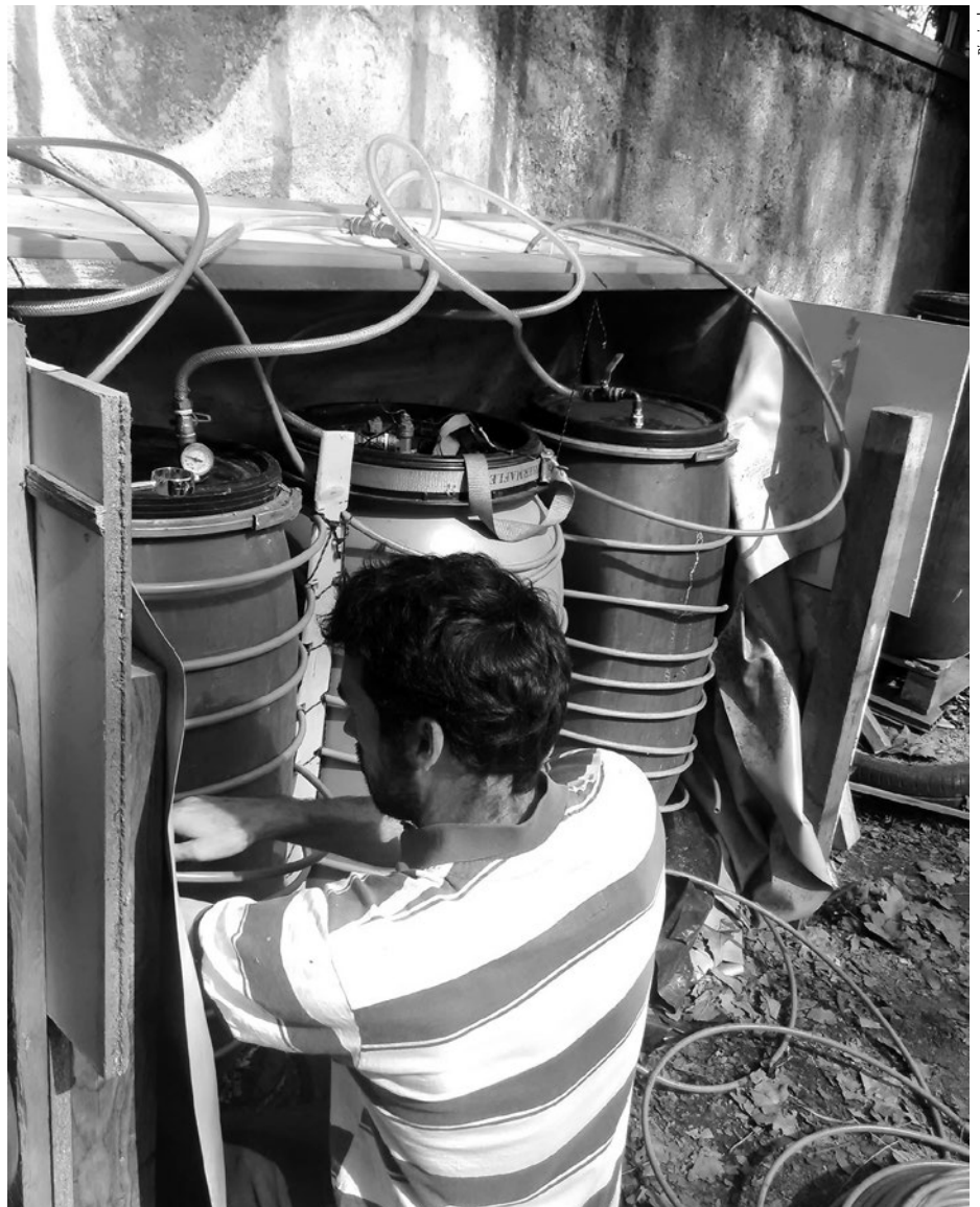
Digesteurs expérimentaux en fûts de 100 litres, installation du chauffage solaire par Antton. Chaque fût contient une "recette" particulière de micro-organismes méthanogènes, et la production de gaz doit être suivie régulièrement.
