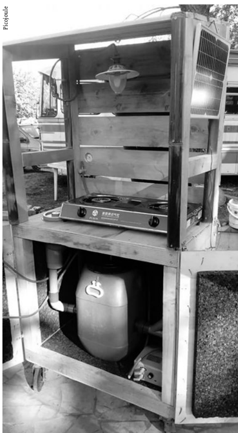
La cuisine mobile réalisée par Picojoule avec le Low-tech lab, support d'animations bio-gaz à roulette : une présentation technique et fonctionnelle des principales réactions de méthanisation et une flamme, dans la lampe ou la gazinière, pour illustrer le tout.
