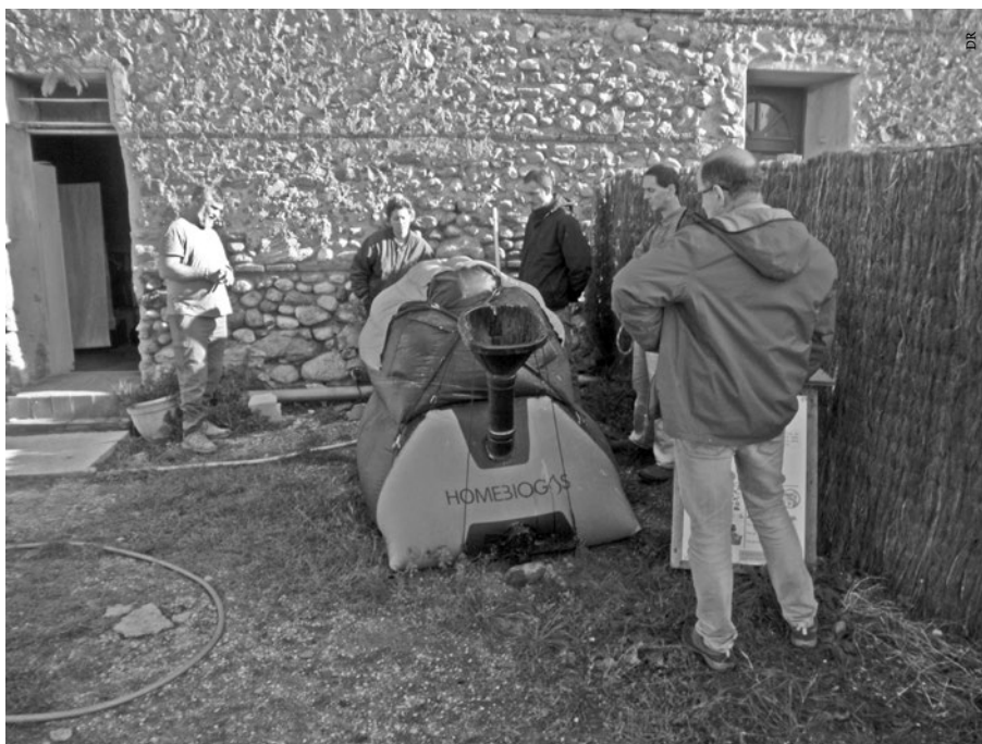
Au Mas Bazan, gîte situé à Alénia dans les Pyrénées-Orientales, une minuscule unité de méthanisation avale les déchets domestiques et permet de produire une heure et demie de gaz de cuisson par jour. L'intérêt réside pour une grande part dans la sensibilisation des personnes de passage dans le gîte, qui se montrent très curieuses, explique le propriétaire des lieux.
