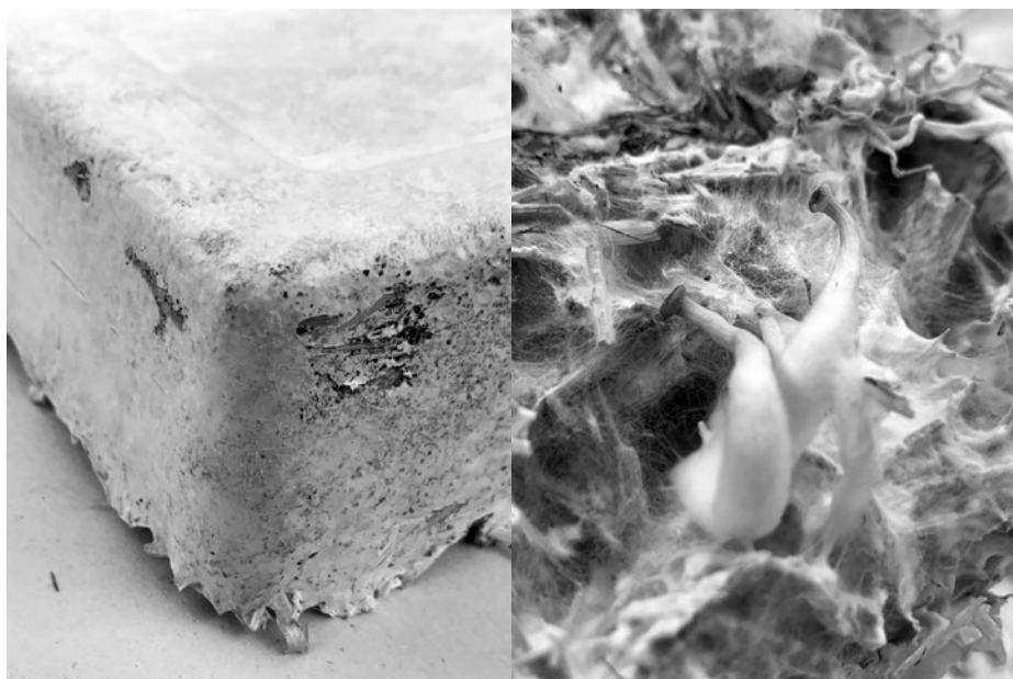
Prototype de biobrique moulée à partir d'un mélange de déchets organiques (paille, marc de café) et de mycélium de pleurotes. Le mycélium se développe en milieu humide en quelques semaines et joue le rôle de liant. De la terre et des gravats, voire des matières polluées, pourraient être incorporés à la brique pour augmenter sa résistance et tirer parti des propriétés dépolluantes des champignons.
