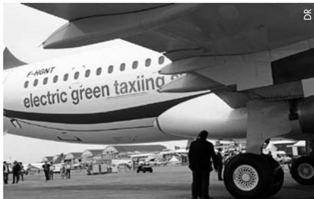
Airbus A320 avec un système de moteur électrique.
