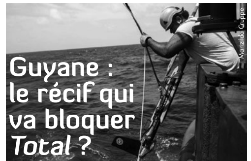
Victor (matelot) lance un sonar, baptisé "fish", afin de cartographier les fonds marins et de déterminer les endroits plus propices à la présence du récif.
