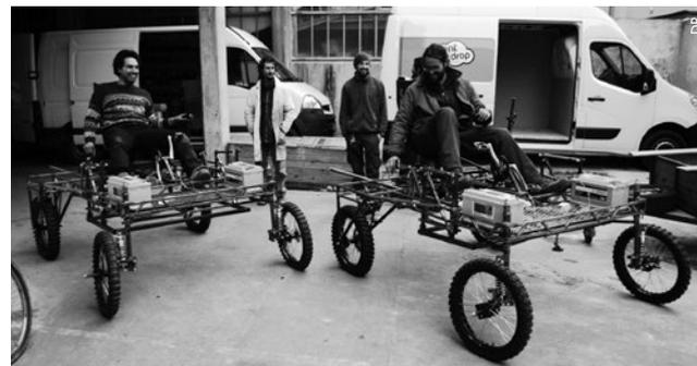
C'est un Aggrozouk, bien sûr ! Anciennement appelée Bicitractor, cette créature extraterrestre va bientôt envahir la Terre ! Porte-outils à pédales, muni d'une assistance électrique, il permet d'atteler des outils agricoles légers. L'utilisateur ou utilisatrice pédale en position couchée et contrôle la direction avec une manivelle à sa droite. Dents de vibroculteur, de herse, disques butteurs,
