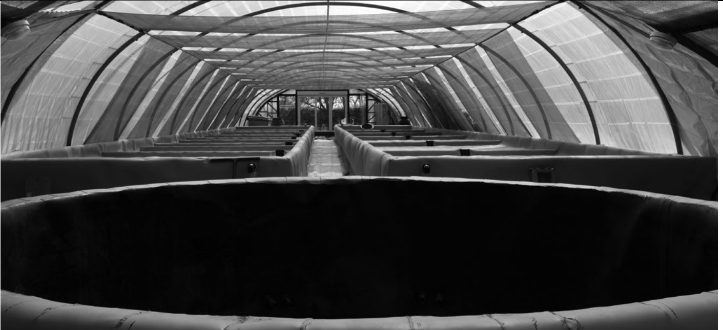
▲ La nouvelle installation de production avec au premier plan un puits profond de plusieurs mètres permettant d'approcher des conditions naturelles de vie de l'algue
