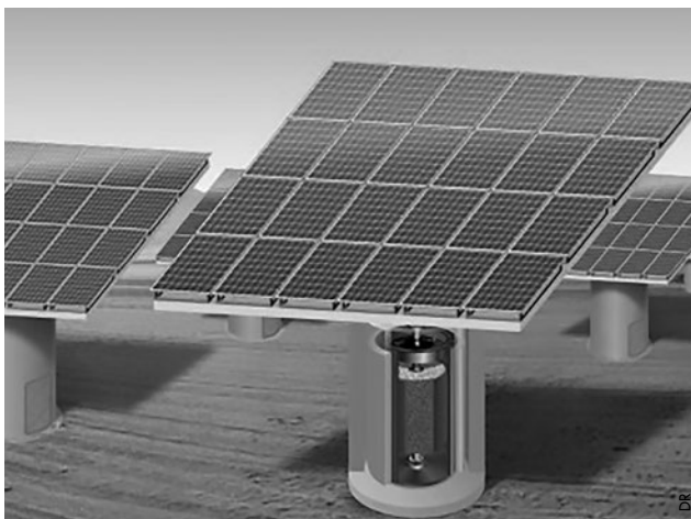
Le volant d'inertie peut être installé dans le pied de chaque série de panneaux solaires
