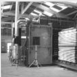
Bois rétifé : séchage à haute température.
